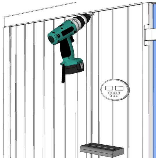
IV. Utilizzate la cornice per nascondere il cavo; inchiodatela assicurandovi che non si trovi al centro di un pannello per evitare di incontrare cavi all'interno di questo.
