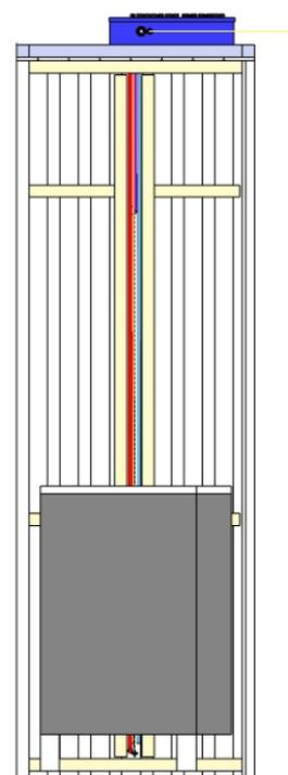
Fig. 1c : vue intérieure de face (avec panneau de câblage sans habillage, montrant le circuit des câbles)
