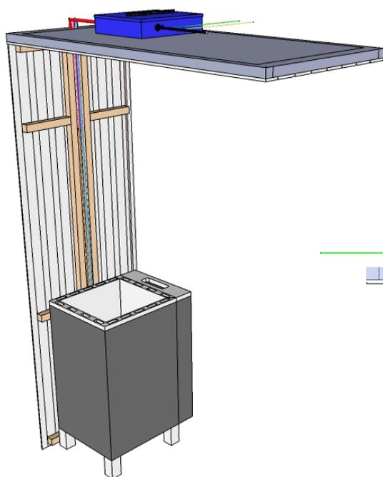
Fig. 1a : vue intérieure (avec panneau de câblage sans habillage, montrant le circuit des câbles)
