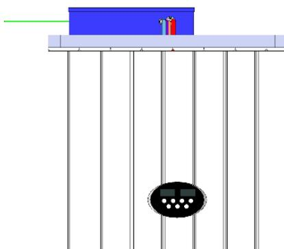
Fig. 1b : vue extérieure. Le boîtier de contrôle est au dessus du plafond, et le clavier de programmation ovale à environ 1500mm du sol, pour une manipulation facile.
